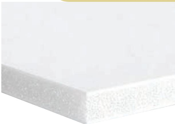
*Pannello sandwich, strutturale, autoportante, composito, multistrato costituito da nucleo in polistirene espanso autoestinguente certificato in classe di reazione al fuoco 1, di elevata qualità, accoppiato a supporti in PVC espanso estruso rigido particolarmente leggero (1mm di spessore) con forte performances fisico meccaniche.*
