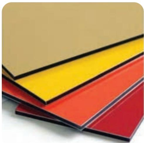
Struttura a sandwich, composta da due lamine di alluminio esterne da 0,5 mm di spessore, laminate a caldo su uno strato centrale più spesso di materiale sintetico. I diversi spessori disponibili si ottengono variando il nucleo centrale. I rivestimenti esterni sono pre-trattati con una verniciatura poliestere durevole nel tempo, che difende dagli agenti atmosferici oltre i 10 anni.
